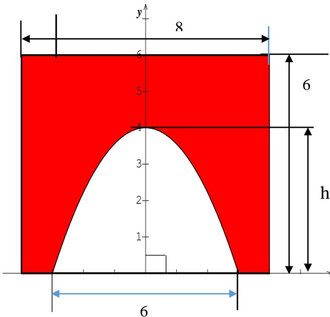
Une autoroute doit couper une voie ferrée. Une entreprise est chargée de construire un pont par-dessus la voie ferrée pour laisser passer l'autoroute. La figure ci-contre est la vue de face, on donne : Longueur totale : 8m
